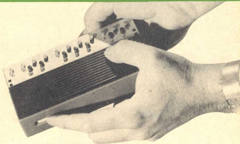
Fig. 9 - Il miniorgano è ormai pronto per l'uso del musicista dilettante. Basta, infatti, ruotare la manopolina di accensione, dosando il volume nella misura più adatta e premendo i tasti corrispondenti alle note musicali.
